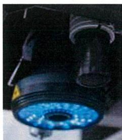
ZEISS DotScanは共焦点の原理を応用した白色光距離センサです。三次元的な微細構造や、ガラスやレンズ等の透明な部品、接触式で測定は変形してしまう柔らかい部品、研磨後の光沢面など、様々なワークの非接触測定を実現します。センサは測定範囲の異なる3種類から選択でき、後からでも異なる測定範囲のセンサを追加することができます。
