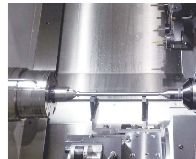
仮受台を用いてオペレーターの負担を軽減
