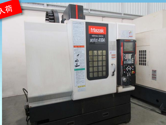
No. 1 CNC 立型 マシニングセンター ヤマザキマザック / VCN410A / 2006年製
