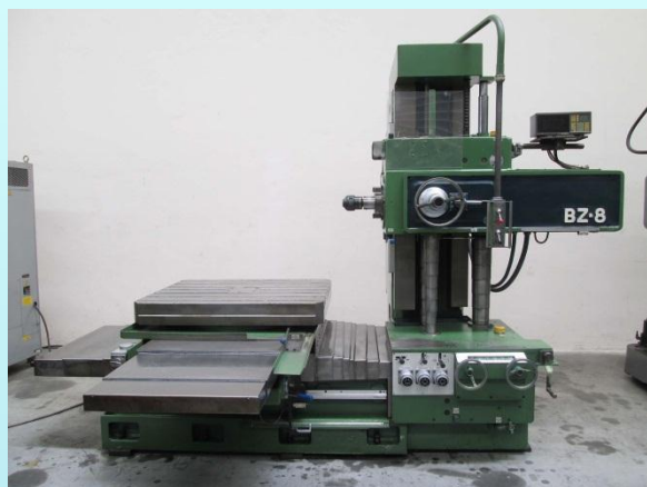
No. 29 横中ぐり盤 東芝機械 / BZ-8 / 1992年製
