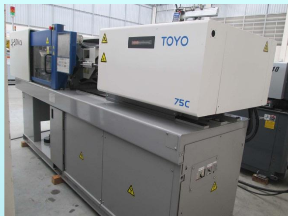
No. 38 射出成形機 東洋機械金属 / Si-50Vcs-D75C / 2012年製
