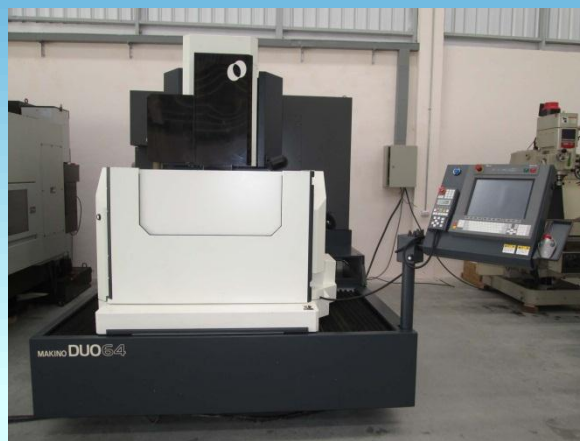
No. 27 ワイヤークット 牧野フライス製作所 / DUO64C2 / 2011年製
